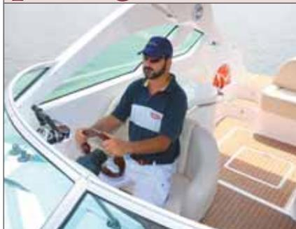
Chega a empolgar. O posto de comando tem banco duplo, assento rebatível e visibilidade ótima. Há espaço no painel para todos os instrumentos, monitor de sete polegadas, vhf e disjuntores. Já o comando mecânico dos motores estava um pouco duro demais.
