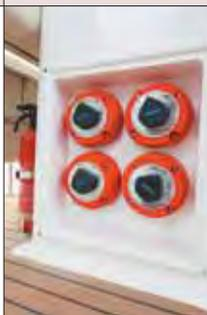
A fiação é codificada, mas não estanhada, embora use dutos e calhas elétricas apropriadas. Todas as luzes a bordo são de leds. O painel elétrico é bom e fica na cabine. Vem com quatro baterias de 150 Ah cada, mas não tão bem protegidas da água.
