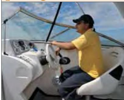
A visibilidade é muito boa, tanto para os lados quanto para a bússola e o painel de instrumentos, que é espaçoso. O para-brisa protege bem o piloto e não atrapalha a visão. Pena que o banco giratório não tenha regulagem.
