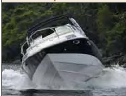
O casco, muito leve (1 300 quilos, sem o motor), usa sanduíche de fibra de vidro com tecido biaxial e é reforçado com espuma de pvc rígida tanto nas laterais, com espessura de seis milímetros, quanto no piso, com 13 milímetros.
