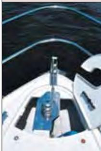
Não há corrimãos nas laterais do convés (os do barco testado foram instalados pelo dono, à parte). E fazem muita falta. Há três pares de cunhos em aço inox 316L, de ótimo tamanho. Os da proa contam com passadores para proteger o casco. O guarda-mancebo, bem resistente, é ótimo.
