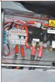
Utiliza cabos estanhados e codificados. São quatro as baterias: duas 12V para os motores e outras duas 12V de serviço. Há um carregador automático de baterias de 60 Ah, circuitos protegidos por fusíveis e disjuntores. Tem um painel de chaves e controle auxiliar de ligação paralela.
