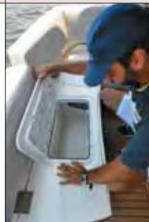
É bem servida de armários e paiois. No cockpit, há ótimos compartimentos sob o sofá, todos interligados, com isolamento e ralo para dreno. O paioi da âncora é bem espaçoso e tem engate para a trava do ferro. Mas falta um chuveirinho para lavar a corrente.
