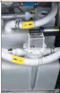
Apesar dos dois tanques de combustível, com capacidade total de 800 litros, tem um só de água, de 250 litros, e uma caixa de retenção de esgoto de 80 litros. Há uma central de conexões hidráulicas sob o piso da cozinha, o que facilita muito a manutenção.
