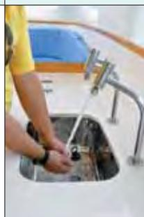
Tem mangueira para lavagem da âncora, o que é bom, pois o ferro está sempre sujeito à lama na hora do recolhimento. O tanque de diesel, de 420 litros, dá uma autonomia de 245 milhas. O de água, de 650 litros, dá e sobra para uma viagem de três dias.
