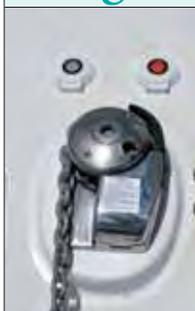
As catracas, em número suficiente, têm bom tamanho, o que facilita as manobras. Porém, a catraca de içamento das bolinas tem pouca redução e, por isso, é pesada. A âncora fica na proa, o que garante melhor ancoragem. Os cunhos, de alumínio, são bem dimensionados.
