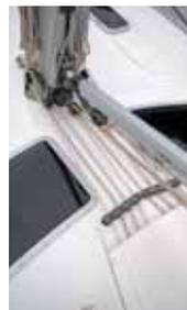
A vela grande tem alto desempenho, com talas verticais bem compridas, que aumentam a área vélica sem prejudicar o sistema de guardá-la dentro do mastro. O cabo que faz a vela enrolar passa por uma catraca. O mastro termina no convés, o que evita a entrada de água na cabine.
