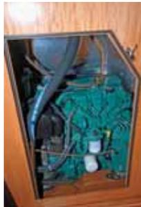
O Volvo Penta D2-75, de 75 hp, turboalimentado, de quatro cilindros, é mais que suficiente para este barco. Tem bom acesso pela escada e pelas laterais, com tampas amplas. Mas sentimos falta de um exaustor, para esfriar o compartimento e tirar o cheiro de óleo diesel.
