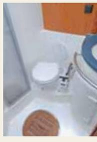
Tem um a meia-nau e outro na suíte da proa, ambos com drenagem automática e vasos com tanque de esgoto (que deve se tornar obrigatório nos barcos navegando próximo à costa). O da suíte tem boxe fechado que pode ser desmontado para abrir espaço.
