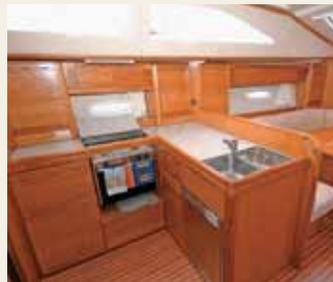
Fica logo na entrada da cabine, o que ajuda na ventilação. O fogão a gás, em aço inox, pode ter duas bocas (como no barco testado) ou três. As duas versões têm forno. As geladeiras são duas, uma horizontal e outra vertical, tipo frigobar. Os armários para guardar alimentos e panelas são fartos.
