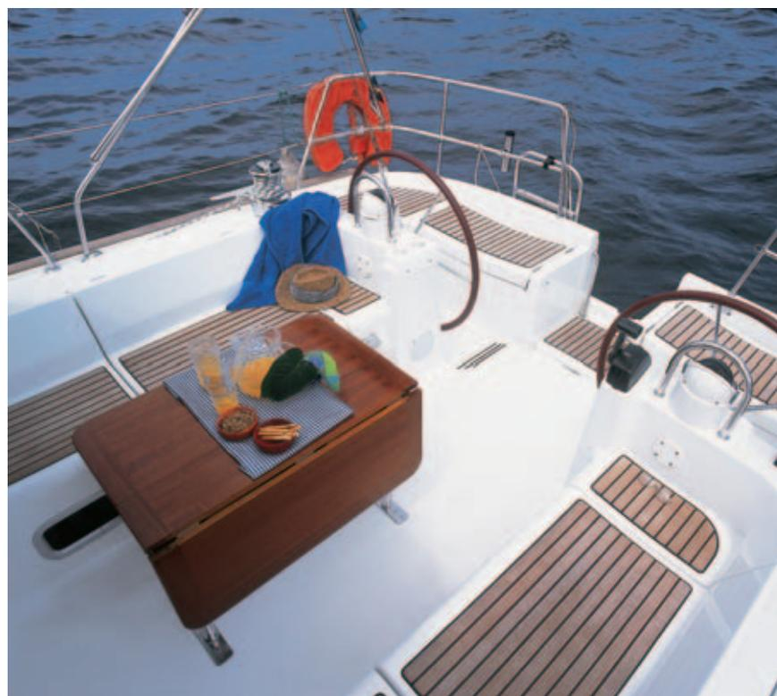
Duas rodas de leme facilitam não só a pilotagem como o acesso ao cockpit
