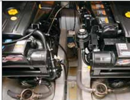
Pode usar um par de motores a gasolina de 300 hp cada ou dois diesel de 270 hp. O espaço para manutenção é bom, com fácil acesso para filtros e correias. Já as varetas do nível de óleo ficam em local um pouco ruim e é preciso curvá-las para retirar, o que pode comprometer as medições.
