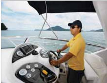
Seu grande painel permite instalar todos os instrumentos e mais um eletrônico de até oito polegadas, com boa visibilidade. O seu topo branco, porém, reflete a luz do sol no para-brisa. O banco do piloto é rebatível, para pilotar em pé, mas não tem regulagem de distância nem de altura.
