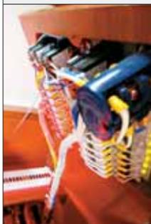
Vem de série com tomada de cais e transformador bivolt, o que permite atracar em marinas com saída de energia de 110 ou 220V. A instalação é bem feita, com fios estanhados (mais resistentes à corrosão), e codificados, o que é o ideal.
