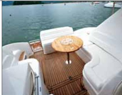
É distribuído em dois ambientes e bem equipado, com duas cozinhas. Não tem antiderrapante na tampa da âncora, o que pode causar escorregões, e a passagem lateral é estreita, com menos de 20 cm de largura — resultado do esforço para aumentar o espaço interno.
