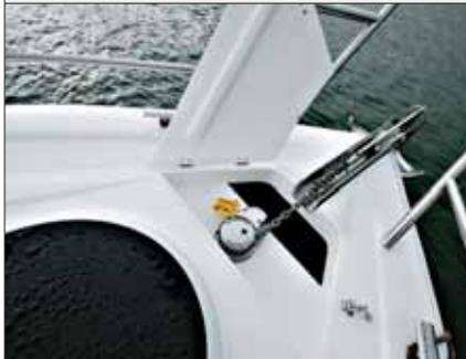
Os cunhos foram bem dimensionados, com dez polegadas de comprimento. A moldura do para-brisa é de aço inox, com tubos de uma polegada e meia de diâmetro, resistente a ponto de permitir usá-la como pegador.
