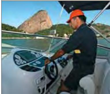
No painel cabem todos os instrumentos dos motores, além de um quadro com 11 disjuntores, rádio VHF e um monitor (opcional) de até 12 polegadas para os eletrônicos de navegação. O assento do piloto é duplo e rebatível, permitindo a pilotagem em pé, com certo conforto.
