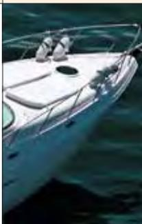
Usa estrutura tipo sanduíche, com espuma de PVC rígida no costado e no convés, o que garante um laminado resistente e leve. Abaixo da linha d'água a laminação é maciça. O espelho de popa é de PVC de altíssima densidade.
