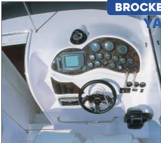
Painel Tem espaço adequado tanto para os relógios da motorização quanto para um eletrônico do tipo “3 em 1”
