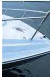
A laminação é forte e o acabamento, caprichado. Para aliviar o peso e reforçar a estrutura, as laterais do casco têm sanduíche de fibra de vidro e uma estrutura de plástico em forma de colmeia que não absorve água caso ocorra alguma rachadura no casco.
