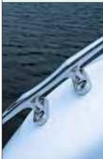
São todas de aço inox 316, que é bem resistente à corrosão. A versão cabinada tem lançador de âncora de série; a Open, não. A âncora é item opcional em ambas. Os cunhos para amarração na proa são insuficientes na versão cabinada e menores do que o desejável na Open.
