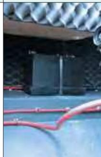
A instalação é benfeita, com fios codificados, estanhados e presos a cada 25 cm, o que é o ideal. A bateria de 100 Ah é de série e fica bem localizada, em lugar ventilado e longe de respingos. A versão cabinada tem um bom painel de fusíveis lá dentro.
