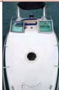
O acabamento da lancha deste teste não era exemplar, mas tratava-se apenas da primeira unidade produzida. As próximas já terão melhor padrão, garante o fabricante. A estrutura é bem reforçada, com duas longarinas que se estendem até o espelho de popa.
