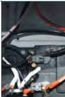
Instalações são benfeitas, com fiação estanhada. Mas falta codificação. As baterias estão muito bem fixadas e com ótimo acesso. Mas cai sobre elas a água do escoamento do cockpit. O painel elétrico fica na cabine e a chave de baterias, no costado — bem longe da água e com fácil visualização.
