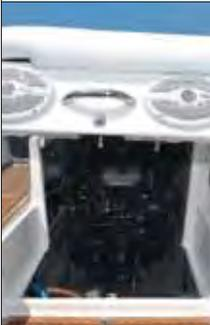
A motorização disponível é bem ampla, embora só de centro-rabeta. Vai de 220 hp a 425 hp. O modelo testado estava com um Mercruiser 5.0MPI, de 260 hp, que mostrou-se adequado. O espaço para manutenção é bom. E o acesso, por um grande tampo no cockpit, é excelente.
