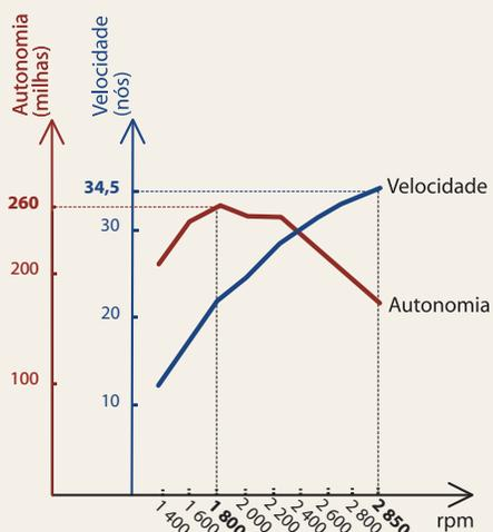
Obs.: 1) A autonomia (baseada em 90% da capacidade do tanque) é dada em milhas náuticas (1 milha = 1,852 km e 1 nó = 1,852 km/h); 2) As velocidades foram obtidas com GPS e radar e o consumo é estimado. 3) Medições feitas com 2 adultos, 220 litros de gasolina e 60 litros de água a bordo.
