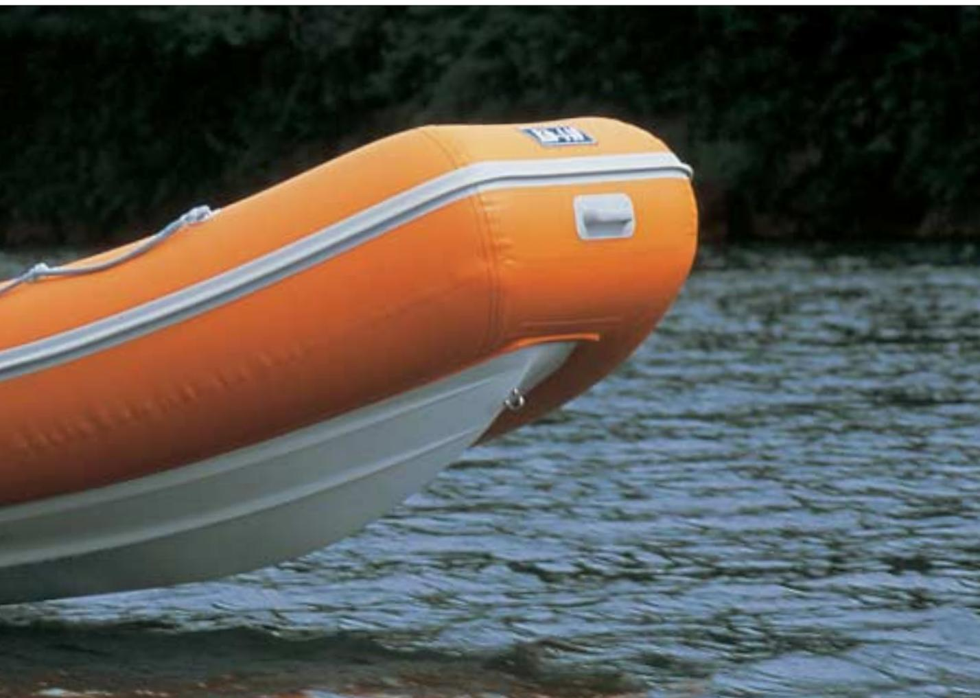
co atrás do console, o barco caturrou um pouquinho até os 3.500 rpm. Mas com o piloto e uma pessoa na proa o problema desaparece. Afinal, todo barco deste porte (4,4 m de comprimento) necessita distribuir o peso a bordo para navegar satisfatoriamente. Geralmente, um hidrofólio fixado à placa antiventilação do motor também elimina este comportamento, contribuindo ainda para abaixar a proa e manter a velocidade de
