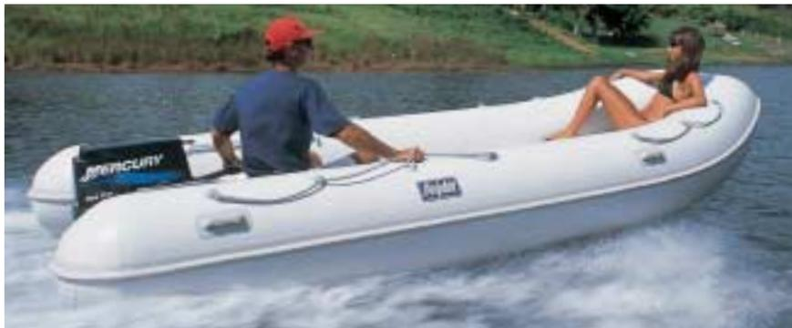
Com um motor de 30 hp, a velocidade é de 23,9 nós (44 km/h)
