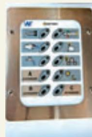
O barco vem com chicotes para as luzes de navegação, mas o painel eletrônico (à prova d'água, com seis botões para comandar buzina, bomba de porão, bomba de água doce, luzes de navegação e acessórios) é opcional.
