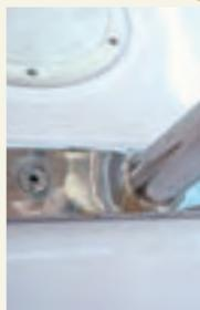
Alguns parafusos, como os que fixam o banco do piloto, apresentam excelente acabamento, mas falta uma proteção plástica nos da targa, que têm cabeça cortante e, por isso, podem machucar. O lançador de âncora é útil, mas pode arranhar outro barco nas atracações de proa.
