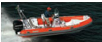
**Onde e como testamos** O Flexboat SR-550 foi testado nas águas da Baía de Guanabara, num dia sem vento e com ondas baixas. A bordo, havia três pessoas, 140 litros de gasolina e 40 litros de água. O motor usado foi um Mercury 115 Optimax, dois tempos, com injeção direta de combustível, 1 526 cm<sup>3</sup>, relação de transmissão de 2,07:1 e hélice de alumínio, de três pás e passo de 19”.
