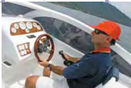
Timão e manete estão corretamente posicionados, mas a moldura superior do pára-brisa fica bem na altura dos olhos do piloto, quando sentado. O painel de instrumentos tem espaço adequado para os medidores do motor, rádio VHF, disjuntores e eletrônicos compactos.
