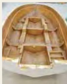
É um dos pontos fortes desta lancha, cujo convés é quase 100% laminado. O casco é reforçado com duas camadas de tecido de fibra de vidro biaxial e madeira maciça no espelho de popa — e tem certificado para o mercado europeu.
