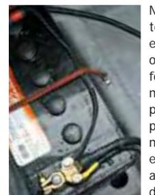
Na lancha testada, os terminais da bateria eram soldados, quando o correto seria que fossem prensados nos cabos elétricos, para evitar quebras pelo balanço do barco na água. Segundo o estaleiro, isso será alterado na montagem das próximas unidades.
