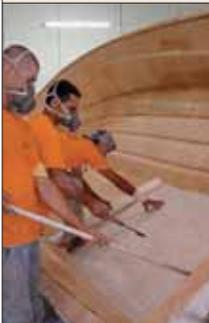
É bem forte. O casco foi laminado da forma tradicional, com camadas de manta, tecido biaxial e triaxial e gelcoat isoftálico, que é bem resistente à osmose. A laminação tem bom padrão de acabamento.
