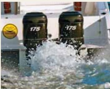
De acordo com o fabricante, podem-se usar dois motores de popa com potência entre 115 hp e 200 hp cada ou apenas um, de 250 hp a 300 hp. Outra opção é um motor diesel de centro com potência entre 260 hp e 320 hp. Com dois motores de popa, o barco fica mais seguro, mas, com o diesel, navega melhor e ainda gera economia na hora de encher o tanque.
