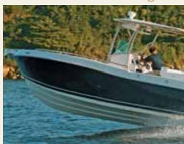
O casco de fibra de vidro usa espuma de PVC rígida acima da linha d'água e laminação maciça abaixo, feita com manta de boa qualidade. Essa combinação assegura bom equilíbrio e estabilidade para a FS 280 Seagull, pois a parte mais pesada fica embaixo do casco.
