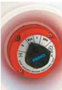
Luzes de navegação e painel de comando com dez disjuntores bem localizados sob o timão são acessórios que vêm de fábrica, assim como tomada de 12 V, útil para carregar celular ou ligar o GPS portátil. A chave geral, item opcional, está bem localizada, junto ao console do motor.
