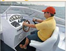
Aqui, dois problemas: o banco do piloto fica um pouco afastado demais do volante e o para-brisa, de moldura larga, atrapalha a visão — um banco com regulagens resolveria os dois problemas. Já o console acomoda bem os instrumentos, que ficam bem visíveis.
