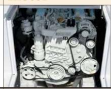
Admite apenas um, de centro-rabeta, que pode ser diesel (de 120 hp a 170 hp) ou gasolina (até 245 hp). O acesso a ele, feito por duas tampas, é bom. Mas o motor a diesel, bem maior que o a gasolina, ocupa praticamente todo o porão.
