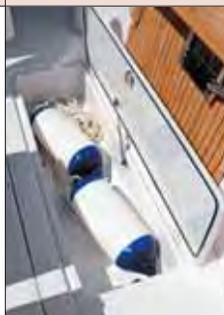
Vem de fábrica com quatro caixas para peixes, todas com juntas de neoprene, amortecedores de aço inox e contramolde, o que é raro. A drenagem é feita para uma caixa de esgoto, o que evita mau cheiro no porão.
