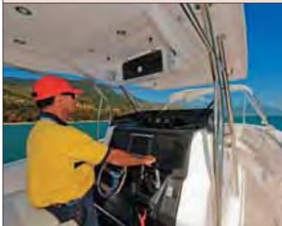
O painel é imenso, com espaço para três monitores de 12 polegadas, além dos relógios dos motores. Para facilitar a manutenção, a parte dianteira do painel é rebatível. Piloto e acompanhantes têm duplo suporte para os pés.
