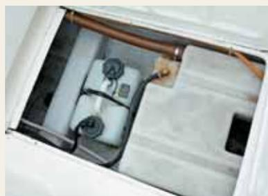
A Fly Fish 210 vem de fábrica com um tanque de água doce de 35 litros, capacidade aparentemente limitada, porém adequada ao porte e ao uso desta lancha. O tanque de combustível está bem localizado, no centro do cockpit.
