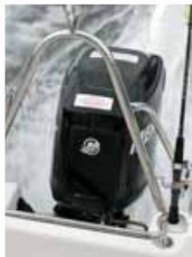
O estaleiro recomenda um motor de popa de 100 a 135 hp. No teste, com um Mercury Optimax de 135 hp, dois tempos e com injeção, o conjunto mostrou-se muito bom e econômico, com a boa marca de um litro por milha de consumo, navegando a 26 nós, sua velocidade de cruzeiro.
