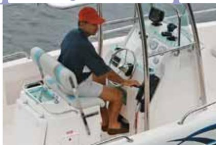
O piloto vê bem a proa e conta ainda com suporte para os pés. Os equipamentos (tela de até seis polegadas, por exemplo) e instrumentos do motor são bem visíveis, mas o manete do acelerador fica muito perto da coluna de aço da capota, o que dificulta o seu manuseio.
