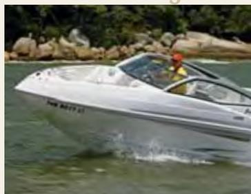
O casco, de fibra de vidro, usa gelcoat com proteção contra os raios solares, o que é bom. Os tanques de combustível e água doce são de polietileno, o que significa que nunca terão problemas de corrosão. Para maior segurança em caso de chuva, o cockpit tem dois drenos que expulsam a água para fora, por gravidade.
