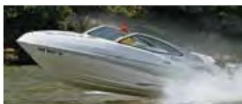
**Onde e como testamos** A Focker 200 foi testada em Balneário Camboriú, Santa Catarina, num dia de mar agitado e ventos nordeste, que sopravam a 15 nós, gerando ondas de 90 centímetros. A bordo, havia duas pessoas e 50 litros de combustível. A lancha estava equipada com um motor de popa Yamaha, de 90 hp, dois tempos, três cilindros, 1 140 cm<sup>3</sup>, com relação de transmissão de 2:1 e hélice de alumínio, três pás, especificação 13,25" x 17".
