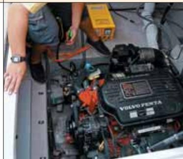
Usa apenas um, de centro-rabeta, de 260 a 420 hp. No teste, estava equipada com um Volvo a gasolina, de 320 hp, e com rabeta com hélices contrarrotantes. Esta motorização se mostrou suficiente para cruzeiros, mas sem muita velocidade final. Já com um motor de 420 hp, a máxima sobe para quase 40 nós.
