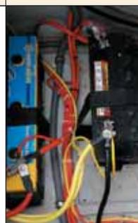
A instalação foi bem dimensionada para suprir a demanda dos aparelhos elétricos. A fiação, estanhada e codificada, é a ideal. O inversor de 600 W e o carregador de bateria (ambos, de série) garantem uma boa rede de 110 V na cabine.
