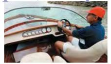
O banco e confortável e fica bem protegido pelo grande pára-brisa de acrílico. Timão e manete do acelerador estão à mão do piloto, assim como os instrumentos do motor. Detalhe: todos os relógios foram feitos especialmente para esta lancha
