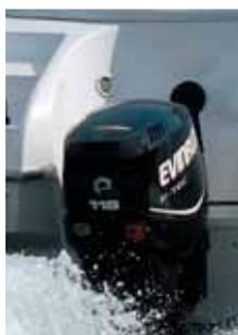
O estaleiro sugere motor de popa de 90 a 150 hp, mas um Evinrude E-tec de 115 hp é suficiente para levar esta pequena lancha aos 37 nós. Motores mais fortes (e, portanto, mais pesados) podem dificultar o planeio.
