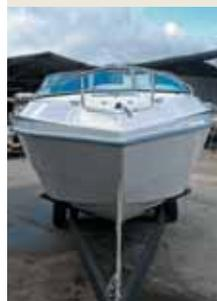
O acabamento não é dos melhores, mas a construção é bem forte e o casco aguenta os impactos das ondas sem ranger ou torcer. Tem duas longarinas, que vão até o espelho de popa, o que reforça bem a estrutura.
