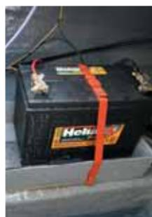
A bateria fica perto do motor e toda a fiação é estanhada, o que é o ideal. Na lancha testada, a chave da bateria estava no paiol da popa, de difícil acesso e sujeito a respingos de água. O estaleiro promete mudar a posição dessa chave.
