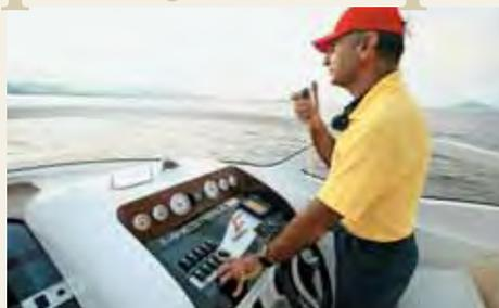
O banco do piloto é duplo e tem assento rebatível. A visibilidade, mesmo através do pábrisa, é boa. O painel tem espaço até para um monitor de cristal líquido de 12 polegadas. Aí também cabem os instrumentos do motor, o quadro de disjuntores e o rádio VHF.
