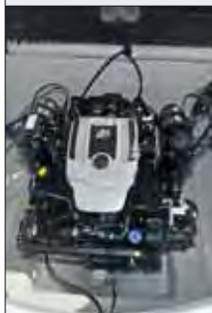
Há 14 opções de motorização para este barco, sendo sete a diesel, entre 170 e 260 hp, e sete a gasolina, entre 260 e 320 hp. O barco testado estava equipado com um Mercruiser gasolina 5.0 L, de 260 hp, com rabeta Alpha One, de um hélice, modelo 17D Mirage.
