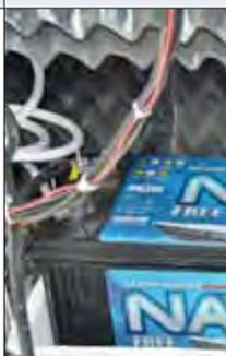
Fiação codificada, mas comum, estanhada apenas nas conexões, e não em toda a fiação, como é desejável. A instalação deve ser melhorada, com conduítes apropriados. Vem com uma bateria bem fixada e protegida da água, e pode receber mais uma, de até 150 ah.
