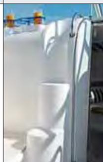
Fibra maciça no fundo do casco, com resina isoftálica na estrutura. No costado, sanduíche de fibra de vidro e poliuretano de média densidade. No convés, resina ortoftálica e sanduíche de fibra de vidro e compensado naval, com reforço de tecido 800 e manta 450.
