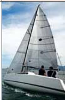
O mastro é de alumínio, com estaiamento de tope e cruzetas anguladas em 20 graus. Todos os cabos são fixados nele, que é apoiado sobre a cabine e tem base basculante (o que permite baixá-lo para reboque). Os ovêns são presos no costado e não atrapalham a circulação.
