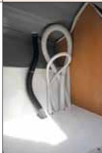
O tanque de água fica sob um paiol do cockpit. Tem bocal de abastecimento externo e capacidade para 55 litros — o suficiente para um dia de passeio. As mangueiras são de alta pressão, específicas para uso náutico, com registros e conexões de boa qualidade.
