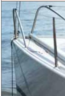
O casco é feito com resina isoftálica e tecidos compostos, com reforços de espuma de pvc estruturais e no convés, que é laminado a vácuo. Há compartimentos estanques na proa e na popa. A montagem e o acabamento são muito benéficos.
