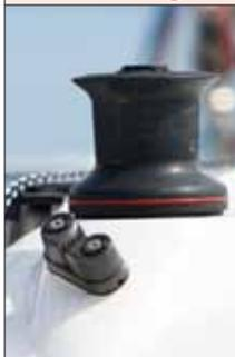
São de aço inox 316, bem fixadas e com tampas de inspeção para facilitar a manutenção. As alças para fixação dos moitões no convés são rebatíveis, mas faltam mais cunhos. Há apenas um na proa e dois na popa.
