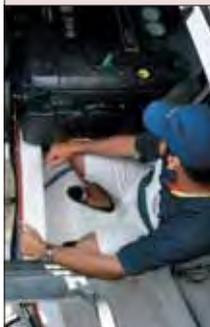
A lancha testada usava um par de motores centro-rabeta, Volvo D4, 4 cilindros, diesel, com 300 hp cada. Deram conta do recado. Mas um conjunto de motores mais potentes, de 370 hp, certamente faria uma boa diferença no desempenho. O acesso para a manutenção na casa de máquinas é excepcional.
