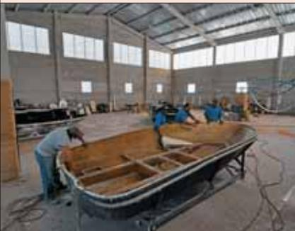
Tem bom padrão e uma estrutura bem reforçada, com duas longarinas e três cavernas. Além disso, o chassi é preenchido com espuma de poliuretano e colado junto com o convés, formando um grande volume estanque, o que deixa o casco virtualmente insubmersível.
