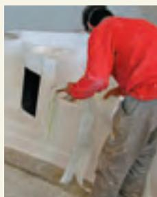
No espelho de popa, o estaleiro usa madeira maciça, mais durável que o compensado naval. O pára-brisa é de vidro temperado com estrutura de alumínio. Já a laminação é convencional, com resina poliéster e gelcoat isofitálico.
