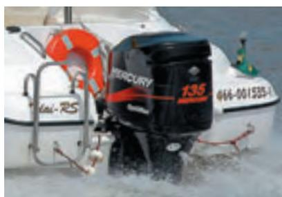
O motor de popa Mercury 135 Optimax, V6, dois tempos com injeção direta de combustível forma um bom conjunto com esta lancha e pode ser usado tanto para passear quanto para esqui. Motorização mais potente só se justifica para os aficionados por velocidade.
