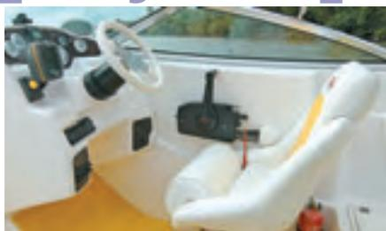
O piloto tem banco anatômico, com regulagem de altura e suporte para os pés. Volante e manete ficam à mão. A visibilidade dos instrumentos é boa, mas o eletrônico deve ser compacto, com tela de, no máximo, 5,5 polegadas.
