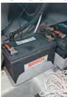
A fiação é codificada, há disjuntores no painel, mas os cabos elétricos não são estanheados. A chave geral tem bom acesso, porque fica no paiol junto ao espelho de popa protegida da água. Mas faltam tiras para fixar as baterias, que, no entanto, são bem acessíveis.
