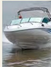
No fundo do casco há sete camadas de fibra picotada e um tecido de fibra de 600 g/m<sup>2</sup>. Já o costado tem uma camada a menos de tecido picotado. O espelho de popa é feito com madeira maciça. O gelcoat tem proteção contra raios ultravioleta.
