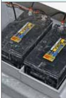
A instalação, com fios estanhados e codificados, torna essa lancha bem segura. Ela já vem de série com três baterias de 220 Ah cada, suficientes para todos os aparelhos elétricos de alto consumo a bordo, como micro-ondas e fogão elétrico.
