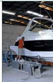
Tem bom padrão de acabamento e de laminação, além de móveis de madeira. Seu espelho de popa é reforçado com espuma de pvc rígida e o gelcoat usado tem proteção contra raios ultravioleta. Opcionalmente, pode ser pintada com tinta que muda de cor.
