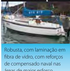
Robusta, com laminação em fibra de vidro, com reforços de compensado naval nas áreas de maior esforço, e lastro que garante boa estabilidade. Mas faltam cunhos à meia-nau e as catracas deveriam ser do tipo self-tailing, que permitem caçar e morder o cabo rapidamente.
