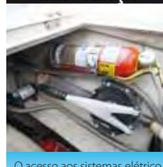
O acesso aos sistemas elétrico e hidráulico é fácil, bem como ao sistema de leme, que é externo e bastante simples. Trata-se de um barco sem luxos e, por isso mesmo, de fácil manutenção, o que é sempre muito bom.
