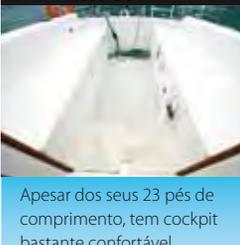
Apesar dos seus 23 pés de comprimento, tem cockpit bastante confortável, autoesgotante, de fácil circulação e com espaço adequado para levar até quatro pessoas. Só o acesso é um pouco dificultado pela popa, que é reta, alta e não tem plataforma.
