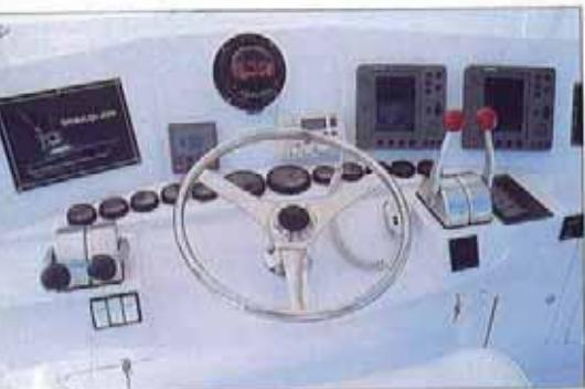
**Painel** Permite acesso fácil ao timão, aos manetes e relógios dos motores e instrumentos eletrônicos de navegação
