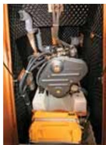
É um Yanmar diesel, de 40 hp, e três cilindros, com acesso por detrás da escada da cabine. A bateria fica bem protegida dentro de uma caixa de plástico, enquanto as pontas das abraçadeiras das mangueiras são de borracha, o que evita acidentes.
