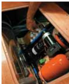
As válvulas do sistema de distribuição de água doce têm fácil acesso. Um aquecedor elétrico de 25 litros, que também funciona quando o motor está ligado, garante água quente nas torneiras da cabine e também no chuveirinho da popa.
