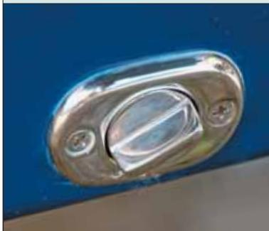
São todas de excelente qualidade, fabricadas com aço inox 316, importado da Holanda. Até o bujão de escoamento de água é de inox! Os cunhos são em boa quantidade e bem-dimensionados. As alças de apoio combinam metal com madeira, o que impressiona no visual.
