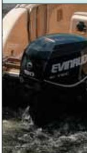
Embora o fabricante recomende um motor de popa a partir de 90 hp, não é o ideal, já que o melhor acabamento deixou o casco bem mais pesado. O novo motor Evinrude E-tec 130 se mostrou bem silencioso e com bom torque.
