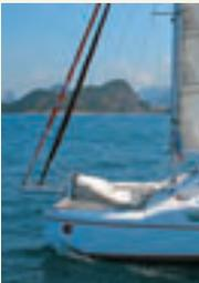
É do tipo fracionada, de alumínio, recebendo um estai de proa, dois laterais e dois volantes, para firmar ainda mais o mastro nos dias de vento e mar nervoso. Verticalmente, tem mais três estais, fixados em cima e embaixo do próprio mastro.
