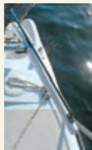
Usa o sistema de canas, construídas com madeira laminada e epóxi. É leve e responde rápido às manobras. A quilha tem um patilhão incorporado ao seu casco, que serve para apoiar o barco no fundo, nos momentos de maré seca.
