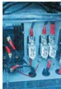
As luzes de navegação são itens de série, assim como as duas baterias, que estão bem presas e ao alcance das mãos, próximas do motor. O quadro de fusíveis está bem localizado e protegido da água, assim como as duas chaves gerais. Toda a fiação é estanhada e codificada.
