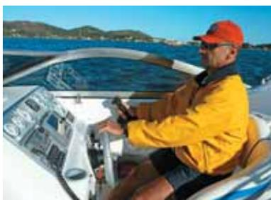
O banco do piloto é giratório, o que facilita a entrada, e rebatível, permitindo pilotar em uma posição um pouco mais alta, mas não tem regulagem — ou seja, não vai para a frente nem para trás, o que faz falta. A visibilidade é muito boa para qualquer bordo da lancha, e os instrumentos, bastante visíveis.
