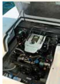
Entre 190 e 320 hp, sempre de centro-rabeta. No teste, um Mercruiser 5.0 MPI, V8 a gasolina, de 260 hp, foi suficiente para levar a lancha a mais de 36 nós. Correias, filtros e varetas de nível de óleo estão bem visíveis e à mão, facilitando a manutenção.
