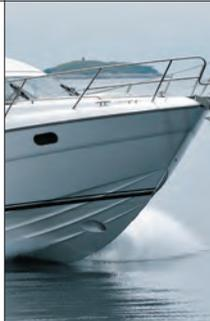
Casco em fibra maciça, com laminação manual, usando resina isofáltica, que previne contra a osmose. O costado e o convés são laminados em sanduíche de fibra de vidro com recheio de espuma de pvc, para maior leveza.
