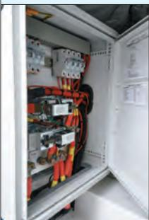
O sistema de bordo é de 24 v e a entrada de cais, 240 v. Há duas baterias para os motores e três para serviço, além de um sistema de segurança de corte geral de energia. A fiação é estanhada, codificada, acondicionada em conduítes e isolada.
