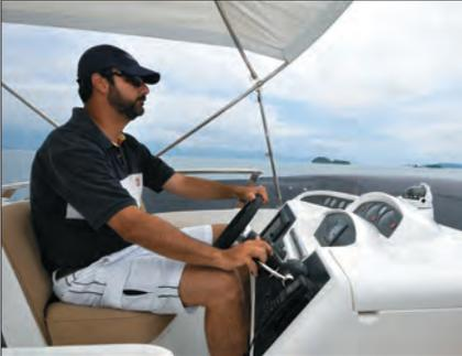
É muito boa, tanto no cockpit quanto no flybridge, que têm a mesma instrumentação — bem completa, por sinal, com monitores de 12 polegadas, ligados ao piloto automático. O único senão é o suporte da capota do flybridge, que balança e faz barulho.
