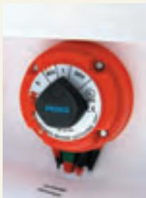
Uma falha: a fiação deveria ser estanhada. Mas os chicotes são codificados e convenientemente fixados à estrutura do barco. Um item bem resolvido diz respeito às chaves gerais, bem localizadas sob um dos solários, acessíveis e protegidas da água.
