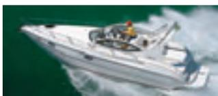
**Onde e como testamos** A Real 29 Class foi testada em Angra dos Reis, em dia de mar sem ondas e com ventos de 6 nós. A bordo, três adultos, 150 litros de combustível e 160 de água. A lancha estava equipada com dois motores diesel de centro-rabeta Mercurier 1.7 L, de 120 hp no virabrequim cada, acoplados a rabetas Alpha One, com relação de transmissão de 2:1 e hélices de aço inox de 2:1.
