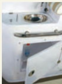
Não é completa, mas no meio da cabine há uma prática pia e espaço para uma geladeira pequena, tipo frigobar, que é opcional. Também é possível instalar um forno de microondas pequeno (nesse caso, é necessário o uso de um inversor).
