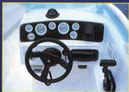
Painel Oferece boa visibilidade dos instrumentos do motor e da bússola
