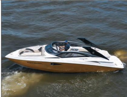
O casco é resistente, mas não tão leve, pois foi construído com fibra maciça, usando resinas e tecidos combinados em três camadas, para maior rigidez. Mas o bom acabamento da laminação chama a atenção.
