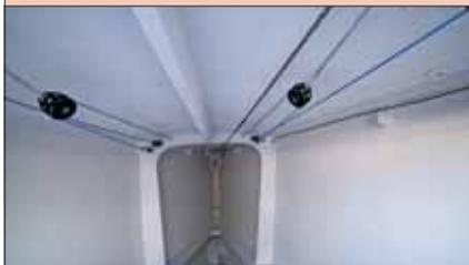
Casco e convés são laminados com fibra de vidro, Core-cell e resina epoxy. Já as estruturas internas, como longarinas e cavernas, são de fibra de carbono, material leve e de grande resistência.
