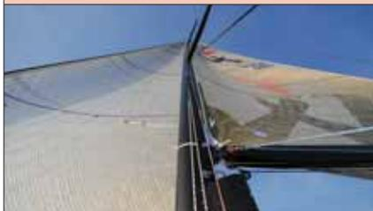
O mastro é de fibra de carbono, para poder suportar os grandes esforços das velas e não elevar o centro de gravidade. As velas são de mylar, reforçadas com fibra de carbono e kevlar.
