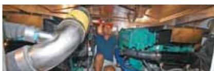
Podem ser dois Volvo, de seis cilindros e 435 cv cada, acoplados à propulsão tipo eixo e pé-de-galinha, que formam um conjunto excelente com o casco. Opcionalmente, podem ser instalados dois motores desta mesma série, porém, com potência de 370 hp. O único senão é o espaço para a manutenção, bem apertado.
