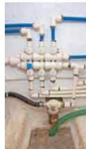
A rede de água doce é feita com material importado, de montagem rápida, desenvolvido especialmente para lanchas e especificado no manual do proprietário. Além de oferecer maior segurança, esse tipo de rede evita vazamentos e facilita a manutenção.
