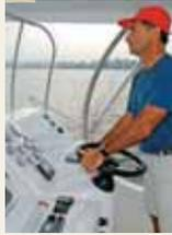
O posto de comando superior oferece espaço de sobra para os eletrônicos (duas telas de 12 polegadas), quadro de disjuntores e instrumentos de monitoramento dos motores. Timão e manetes estão bem posicionados em relação ao piloto, que tem visão total da popa.
