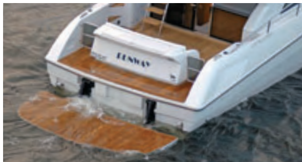
Plataforma elevatória: facilidade para subir um bote ou um jet
