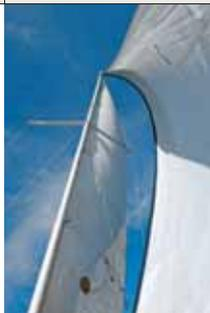
Tem mastro fracionado em 9/10 com regulagem de inclinação, para melhorar o desempenho. A retranca tem boa altura e a redução do backstay facilita caçar o mastro.
