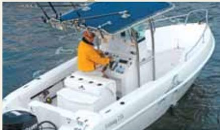
Apesar de o console, o banco de pilotagem e o viveiro central serem bem grandes, há bom espaço para a circulação, característica fundamental em uma lancha de pesca. Para maior segurança, o cockpit tem drenagem direta para fora, importante quando se navega em mar agitado.
