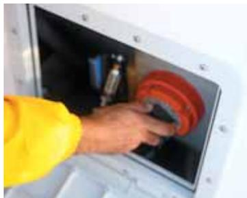
Os fios são do tipo estanhado, mais resistentes à corrosão que os de cobre. Além disso, esta lancha vem de fábrica com caixas para duas baterias, luzes de navegação e até quatro luzes de cortesia. Já as chaves gerais, a bomba de porão e o sistema de pressurização de água doce e salgada são opcionais.
