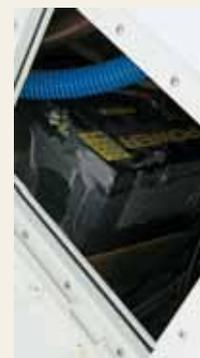
Toda a fiação é estanhada e os conectores são à prova d'água, no mesmo padrão dos chicotes automotivos, o que é bom. Vem com seis luzes de cortesia no cockpit e caixa para duas baterias, mas os terminais elétricos são soldados, quando deveriam ser fixados por prensagem.
