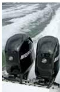
Dois motores de popa Mercury quatro tempos, de 115 hp cada, formam um bom conjunto com esta lancha. Em regime de cruzeiro (29 nós a 4 500 rpm), permitem navegar 145 milhas com o tanque-padrão, ou seja, com a boa marca de 1,39 litro para cada milha percorrida.
