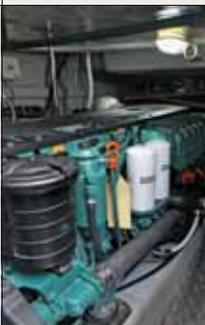
Podem ser tanto de centro (um par de 370 a 600 hp cada) quanto IPS 600, como neste teste, quando apresentou boa velocidade final. O compartimento dos motores tem bom espaço para manutenção e vem até com câmera para ser monitorado no comando.
